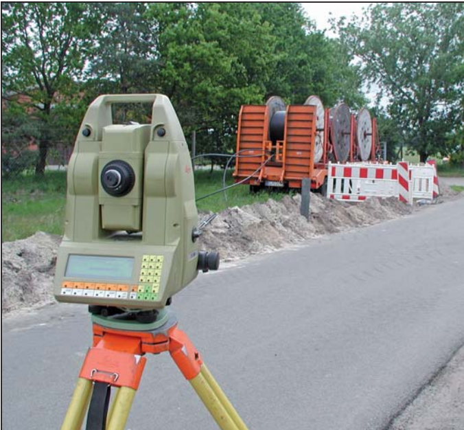
Mit einem Tachymeter werden Punkte nach dem Polarverfahren aufgemessen.
